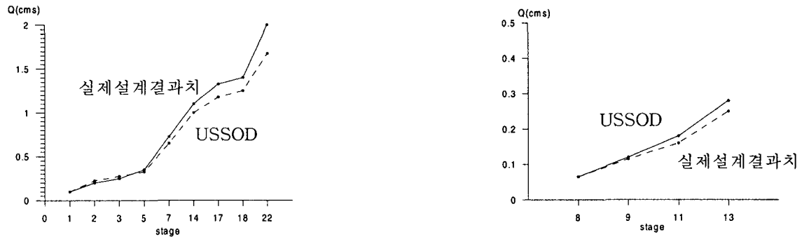
<그림 6> 주 연결 관로와 분기 연결 관로에서 USSOD-2와 실제설계치의 설계유량 비교
