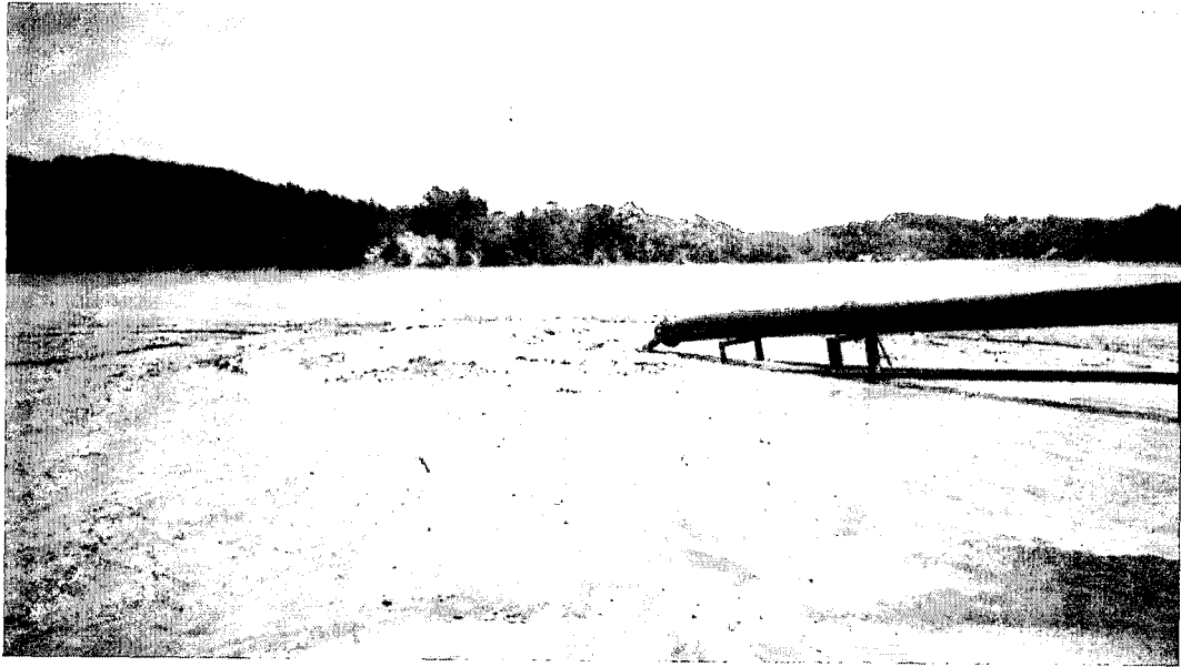
그림 1. 국내의 한 회처리장(ash pond)에서 석탄회 이송관을 통하여 이송수(slurry water)와 함께 석탄회를 처리장에 처리하고 있다. 사진의 저수지는 이송수가 고인 물이며, 처리장이 연안에 위치하는 관계로 보통 해수를 이송수로 이용한다.
