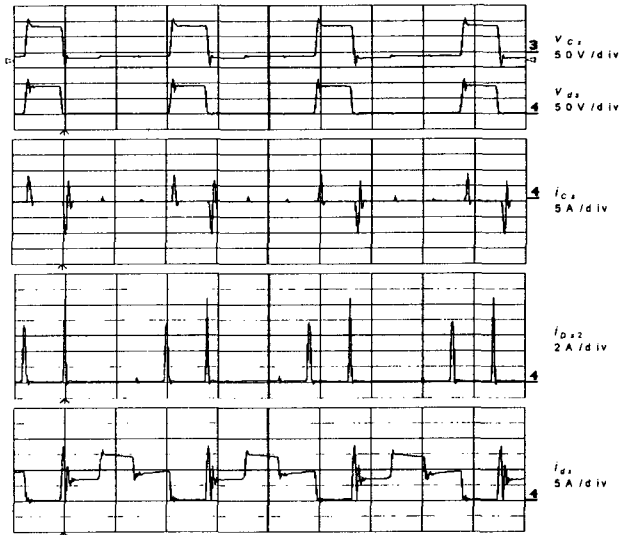
그림 6 설계 1( C_s=0.082\mu F , L_s=3\mu F )의 실험 파형 Fig. 6 Waveforms of Design 1( C_s=0.082\mu F , L_s=3\mu F )
