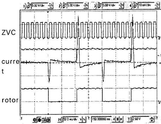
그림 6. 자속밀도 1.2 (T), 입력전압 140V 에서의 파형
