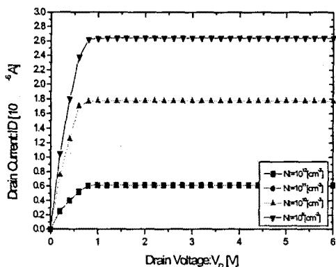
그림 5 트랩 농도에 따른  $I_D$ - $V_D$ 의 변화( $V_D=V_G=5V$ )
