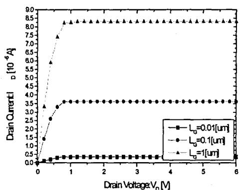
그림 6. 그레인 크기를 변화시킬 때,  $I_D$ - $V_D$  특성
