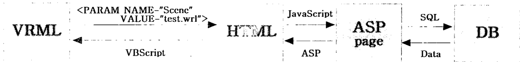
<그림 2> ASP를 이용한 VRML과 DB연동 흐름도
