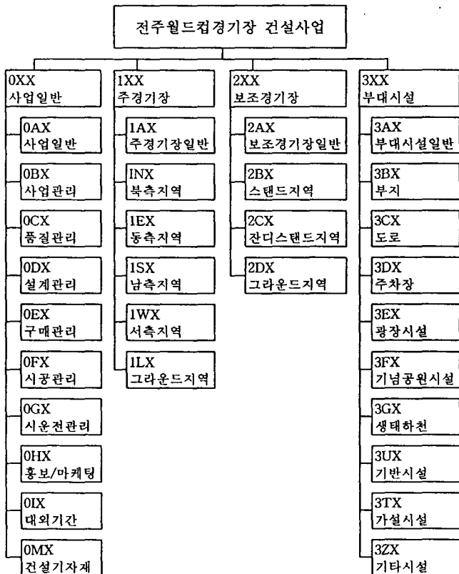
그림 6. 전주월드컵경기장 건설사업 WBS
