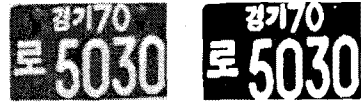
(a) 임계값처리 전 (b) 임계값처리 후 그림6. 차량번호판 문자분리를 위한 임계값처리 전후의영상
