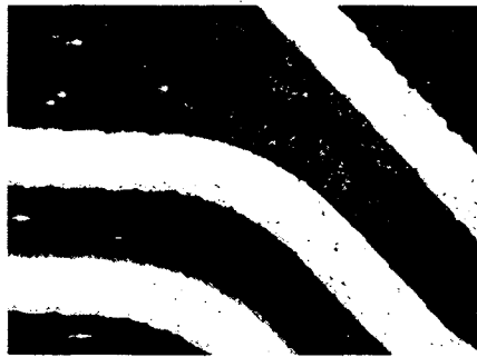
<그림 2> membrane pattern간의 Ag Ion migration 현상
