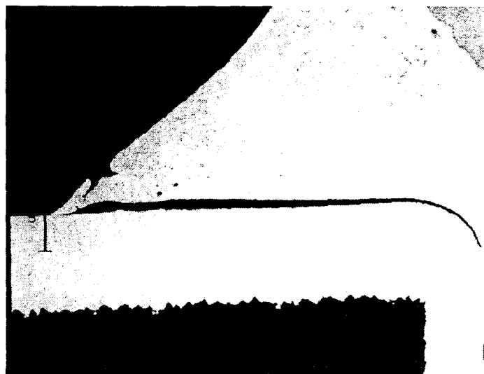
그림 6 Sn-3.5Ag 무연 솔더링부에서 리프트 어프가 발생한 예
