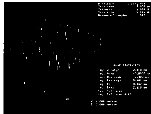
그림 6. Al 2 O 3 박막의 AFM 사진 (300 °C)
