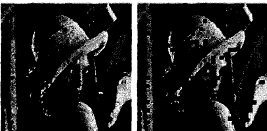
(a) 채널 통과후 복원 영상 (PSNR : 24.52 [dB]) (b) CRC를 사용하여 에러 블록을 체크한 영상 (PSNR : 27.64 [dB])
