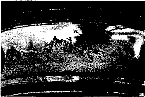
Fig. 3. 파손된 베어링의 내륜.
