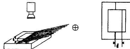
(a) (b) 그림 2. 라인광에 의한 삼각측량 원리
