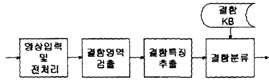
[그림 3] 자동시각검사 시스템 구조
