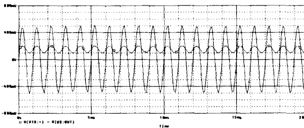
<그림 11> DC 150mV에서 1KHz입력(0 to 20ms)
