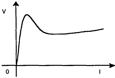
그림 1 점등특성 Fig. 1 Characteristics of the firing
