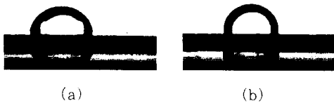
그림.5 금표면에 떨어뜨린 (a)SAMs 도포하기 전의 물방울 모양과 (b)도포 후 물방울 모양
