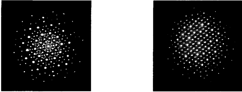
그림1 (a)준결정의 5회 대칭 diffraction pattern (b) rhombohedral [001] diffraction pattern
