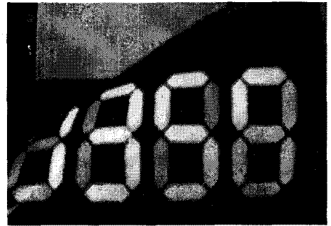
그림 8 휘어진 상태로 동작중인 정보 표시형 후막 EL 소자
