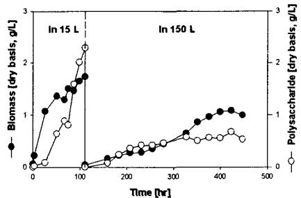
2. 일반적인 다당류 생성 배지인 glucose 배지와 B-I 배지의 생산 수율을 비교한 결과 B-I 배지의 수율이 11배 높았다. 그리고 B-I 배지의 최적 농도는 보리 1.0%, 식염 0.5%였다. 다당류의 scale-up 생산은 P/V 및 gas throughput number를 기준으로 설정한 것이 훨씬 효과적이었다.
