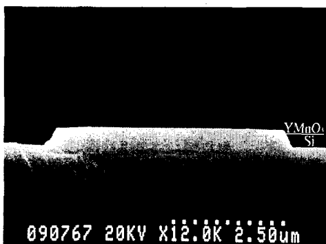
그림 6. Cl 2 /Ar = 8/2인 조건에서 식각한 YMnO 3 박막의 SEM 단면 사진
