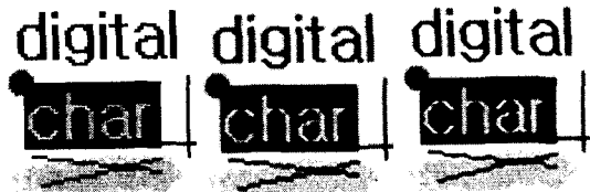
그림 6) 합성된 디지털 글자 이미지의 2배 확대 (좌) 0차 보간 (중)bicubic 보간법 (우) 제안된 보간법
