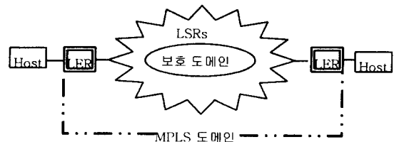
[그림 1] 일반적인 MPLS망에서의 MPLS 도메인과 연결 복구를 위한 보호(Protection) 도메인
