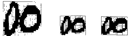
a) 입력 패턴 b) 정규화된 명암 c) 이진화된 매쉬 P 35×27 매쉬 R 20×16 매쉬 R 20×16
