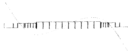
Fig.3.3 스피들 시스템의 3차 고유모드 해석결과 [159.184Hz]
