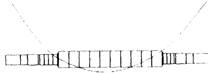
Fig.3.2 스피들 시스템의 2차 고유모드 [67.5636Hz]
