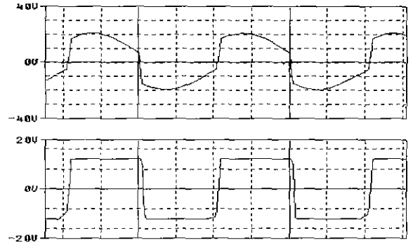
그림 10 Half-Bridge 직렬 공진 컨버터 시뮬레이션 파형 PCB 변압기 1차측 전압(위),2차측 전압(아래)
