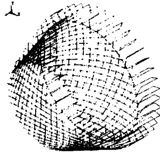
그림5 고정자 권선 모델링 (isotropic view)
