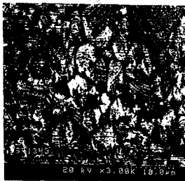
그림2-4. 3급 바리스터 표면의 SEM 사진 (바리스터 전압이 높은 경우)
