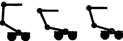
그림 8 r_0 이 0.01인 경우의 조정성만을 고려한 peg-in-hole작업의 자세
