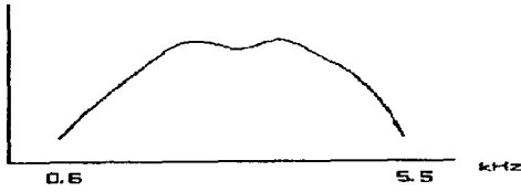
【그림 2】 Bandpass Filter 스펙트럼 형태
