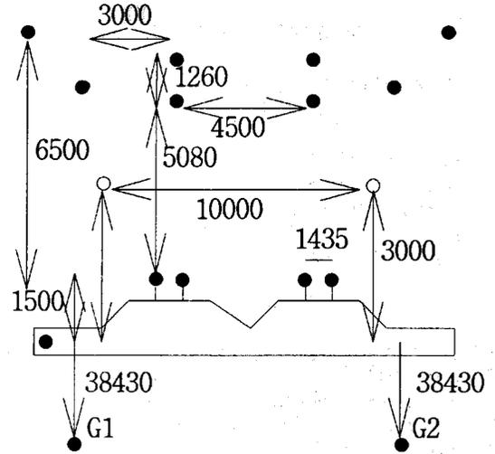
그림 3. 고속전철 급전시스템에 보조도체를 설치한 그림
