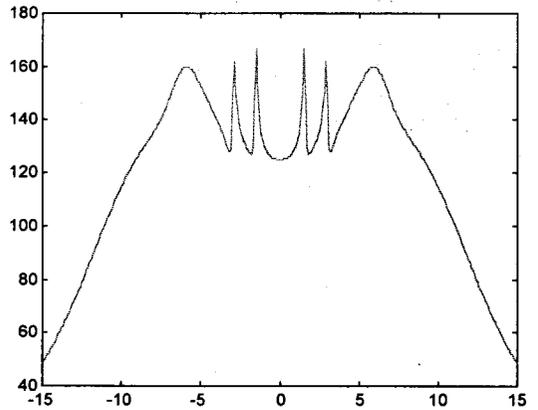
그림 4. 자계감쇠를 하지 않았을 경우 (Max: 166.655[mG], Min: 48.4912[mG])
