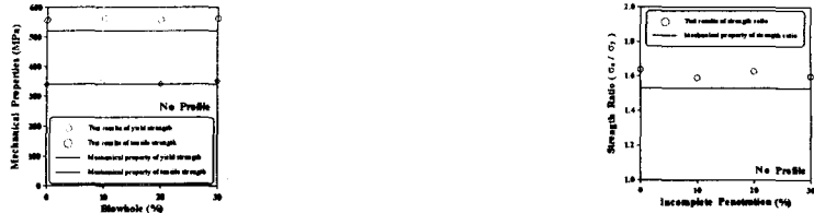
(a) 인장강도 및 항복강도의 변화특성 (b) 항복강도에 대한 인장강도 비 그림 14. 비드를 삭제한 시험체의 정적강도특성
