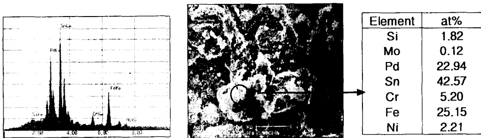
[그림 3] 15회 활성화 처리한 시료의 SEM 및 EDS 분석 결과
