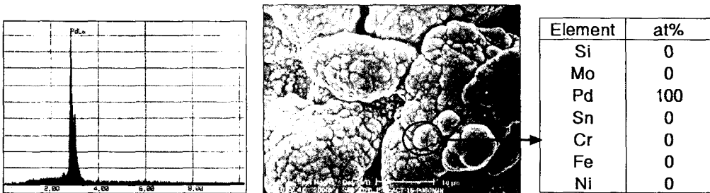
[그림 5] 15회 활성화 처리한 시료의 Pd 도금 결과
