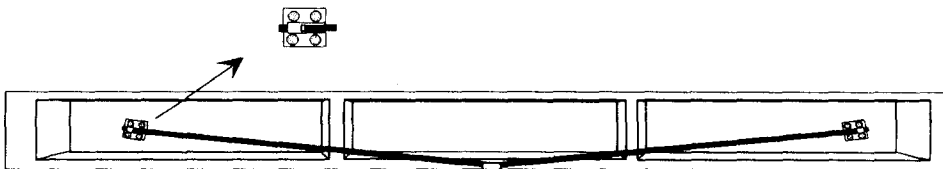
그림 2 마찰지지 방법에 의한 외부 프리스트레스 도입
