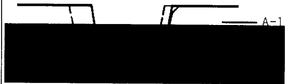
그림 2. 제체 구성재료 혼합비에 따른 붕괴부 최종 횡단면
