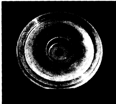
(c) shear stress에 의한 파손
