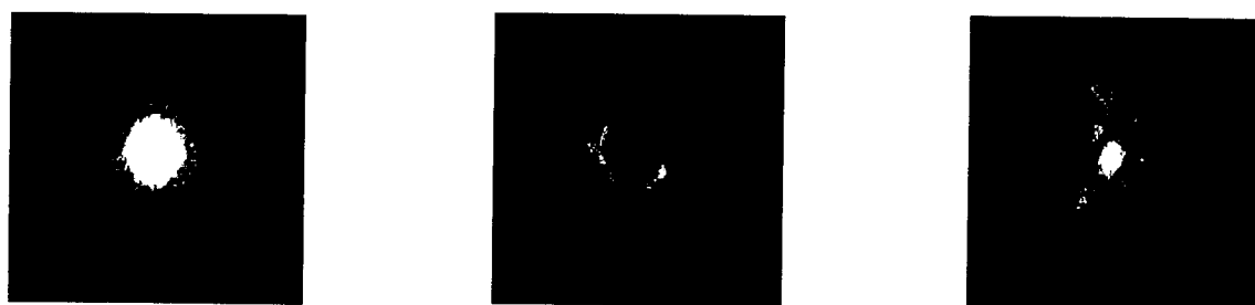
그림 3. \text{LiNbO}_3 를 통과한 빔패턴 (a) 도파로 제작전 (b) 제작후 (c) 두 개의 가우시안 빔으로 만든 도파로를 통과한 빔패턴
