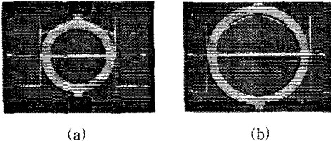
그림 7. 인장 응력시의 링 구조물의 형상 (a) 링의 반경 = 45\mu\text{m} (b) 70\mu\text{m}
