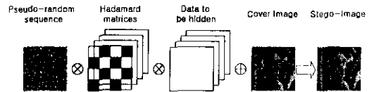
그림 1. 랜덤 시퀀스와 Hadamard code를 이용한 정보은폐 과정
