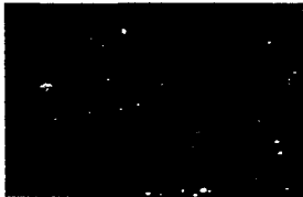
그림 2. 전사배향법을 이용한 네마틱액정의 편광현미경 사진 Fig. 2. The microphotograph of aligned NLC by transcription alignment method on PI surface.
