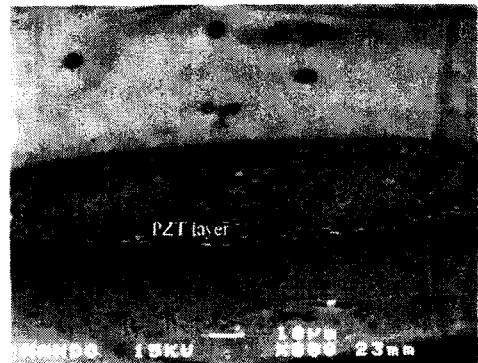
그림 4. SEM으로 관찰한 PZT film의 식각 상태 Fig. 4. The etching condition of PZT film observed by SEM
