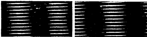
(a) 움직이기 전 이미지 (b) 3\mu\text{m} (주기/2) 이동한 이미지 그림 7. 선형 격자에 의해 형성된 moiré 무늬
