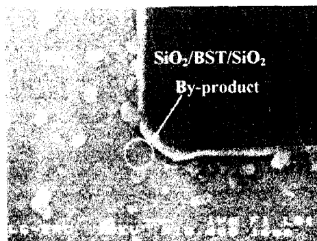
그림 4. Ar / Cl 2 = 8 sccm / 32 sccm, Pressure = 10 mTorr, RIE = 150 W, ICP = 700 W 에서 식각한 BST 박막.
