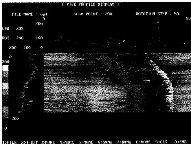
그림. Pipe 용접단면 측정 결과
