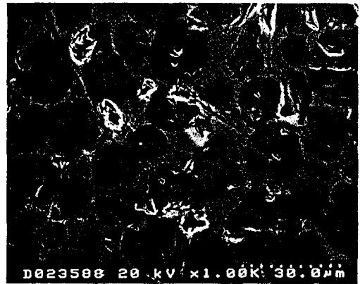
그림 6 조성 B(1350°C소결)의 SEM 사진
