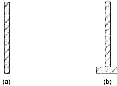
fig. 2 Model Walls; (a) I-wall, (b) cantilever wall ( heel ; 0.10H, 0.12H, 0.20H)
