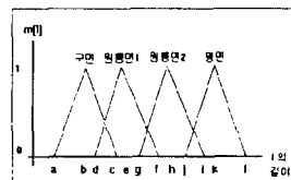
그림 3. 장축의 퍼지함수 Fig. 3. Fuzzy membership function of the long axis
