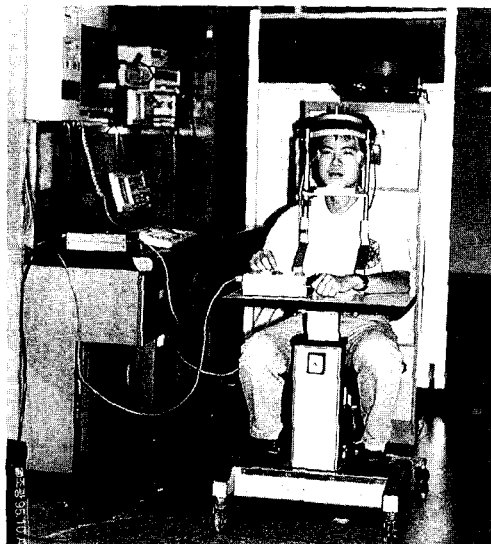
그림 2. 전극을 부착한 상태로 얼굴 고정대에 얼굴을 고정하고 있는 피검자의 모습.
