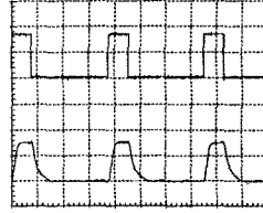
그림 5 가변전압원 구동시 상전류(5[ms/div], 4[A/div]) Fig. 5 Phase current of VSS driven SRM (5[ms/div], 4[A/div])
